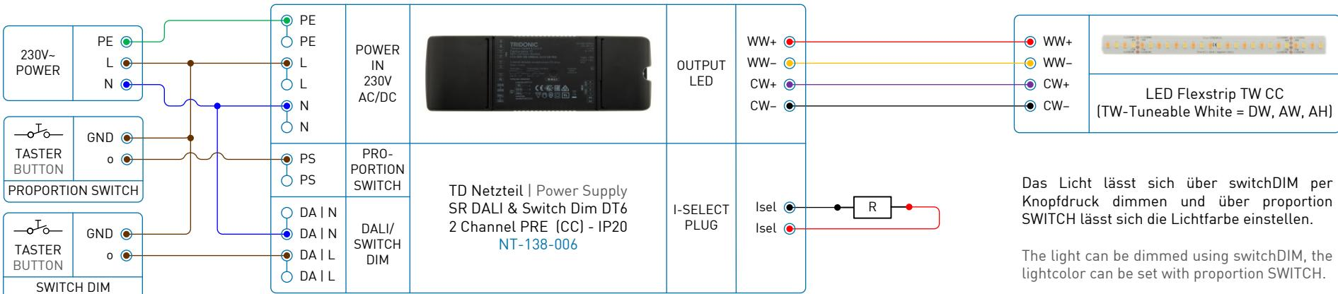
Der Ausgangsstrom kann mittels Einstektwiderständen, Programmiergerät oder DALI eingestellt werden. Wird kein Widerstand oder Drahtbrücke zwischen den I-SELECT Anschlüssen gesetzt, so gilt der am Gerät niedrigste Ausgangsstrom. Wird eine Drahtbrücke am I-SELECT Anschluss gesetzt, so gilt der am Gerät höchste Ausgangsstrom. Für Einstellwerte dazwischen werden Einstektwiderstände benötigt.
