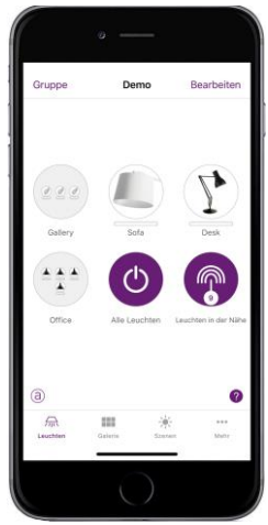
Hauptsteuerung mittels iOS oder Android Gerätes. Kommunikation via Bluetooth und 4remote BT App.
