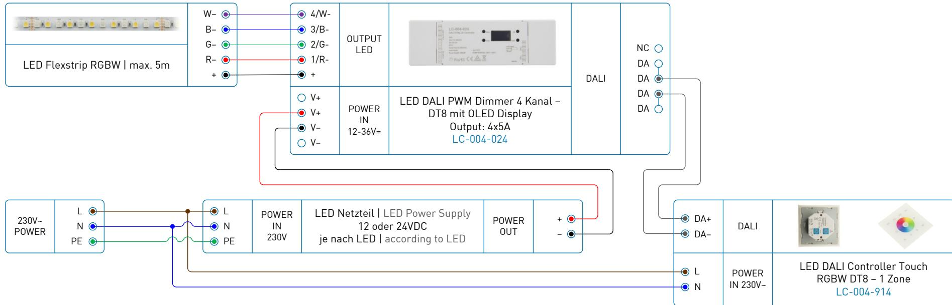
Aktiv: Bei einer Spannungsversorgung mit 230VAC stellt das Touch Panel eine DALI Busversorgung von 100mA zur Verfügung und kann somit bis zu 50 DALI Aktoren ansteuern, wenn diese eine standardmässige DALI Stromversorgung von 2mA benötigen.
