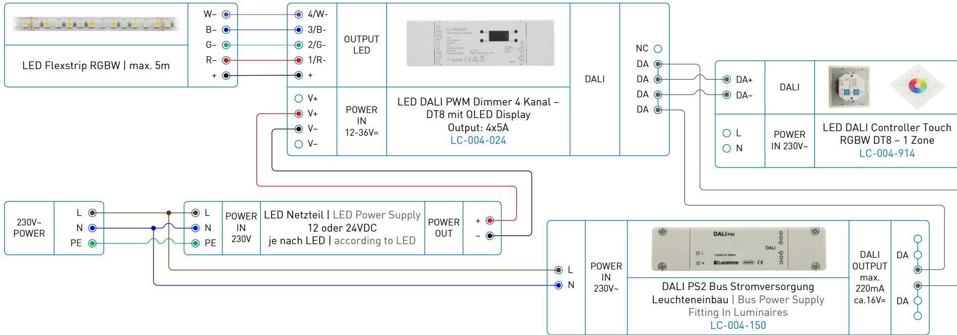
**Passiv:** Wird das DALI Touch Panel passiv angeschlossen so bleiben die Klemmen L und N für den 230VAC Anschluss unbelegt und das Touch Panel bekommt die Busspannung von einer externen DALI Busversorgung.
