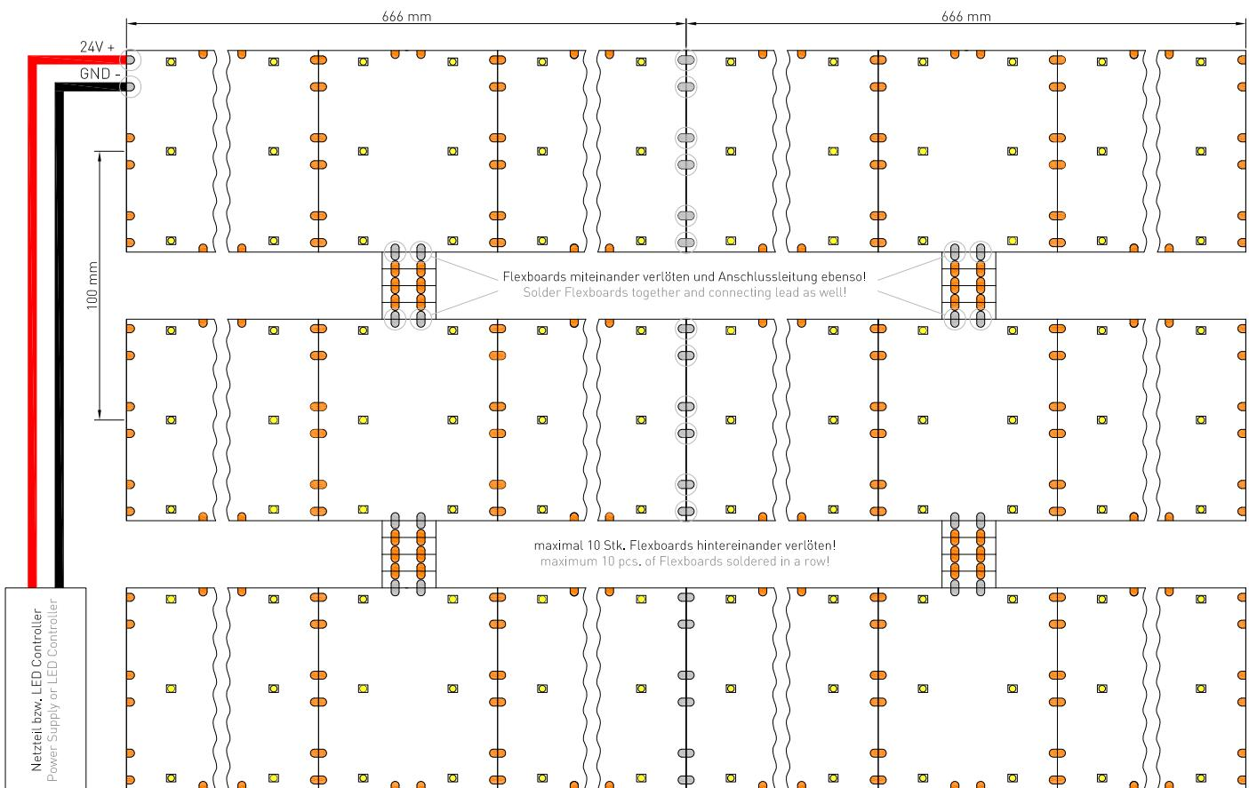
Bei Verwendung von mehreren Netzteilen bzw. LED Controllern müssen die LED Flexboards untereinander galvanisch getrennt sein und es darf keine Verbindung zwischen den einzelnen Stromkreisen vorhanden sein!
