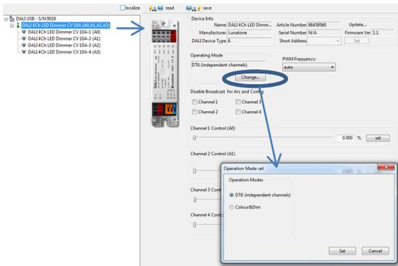
Außerdem kann auf der Übersichtsseite die PWM-Frequenz gewählt werden und in jeder Betriebsart stehen Steuerelemente zum Testen der Funktion zur Verfügung (4 Schieber für die Helligkeit jedes Kanals in der Betriebsart DT6 und je ein Schieber für Helligkeit und Farbe in der Betriebsart Colour&Dim). Optional kann auch die Broadcaststeuerung einzelner Kanäle deaktiviert werden.
