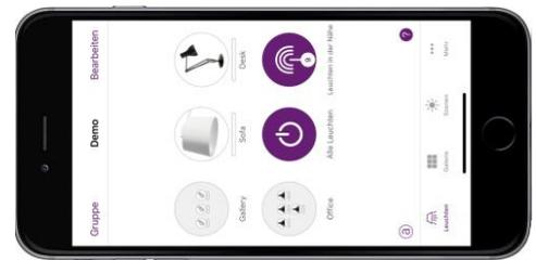
Hauptansteuerung mittels iOS oder Android Gerätes. Kommunikation via Bluetooth und 4remote BT App.
