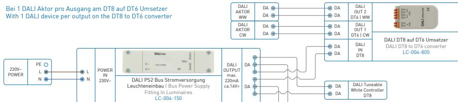
Bei mehr als 1 DALI Aktor pro Ausgang am DT8 auf DT6 Umsetzer wird ein Expander benötigt.
